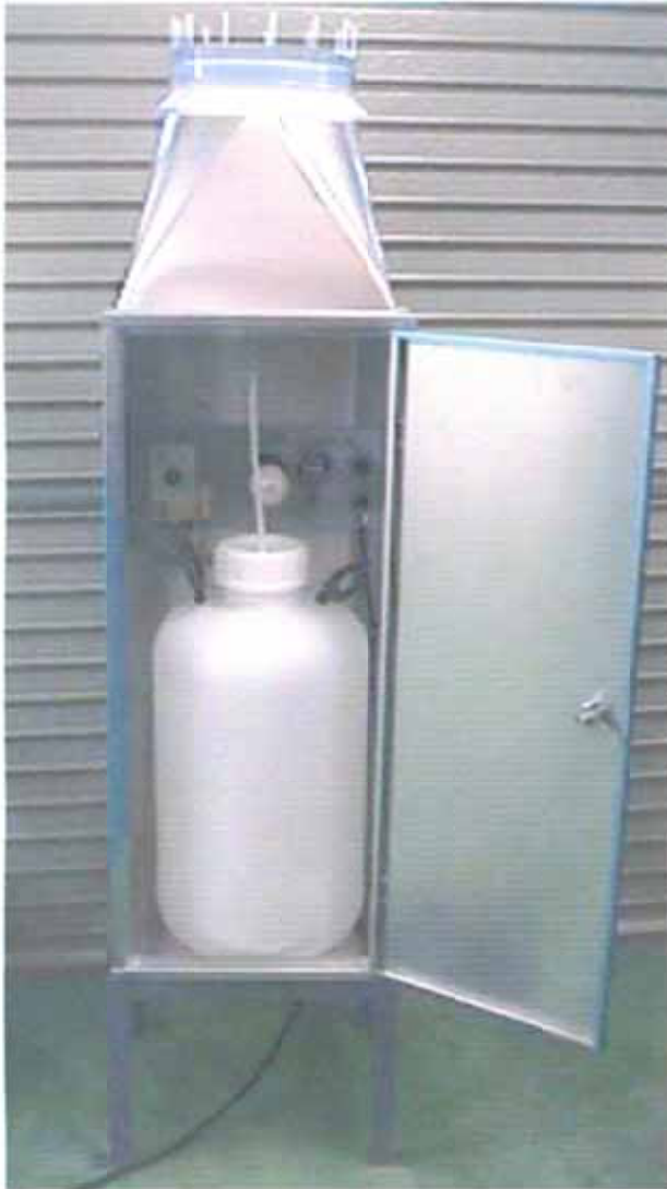
ST-1F型(ロート \phi 210mm)ロート部交換可能 (写真は鳥よけ防止器取付タイプ)
